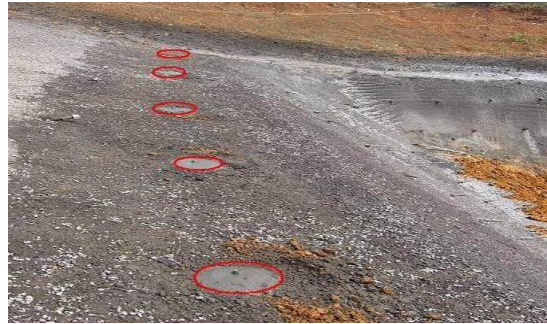
Slika 20. Tačke mjerenja za mjerenje slijeganja tla u plitko ukopanim presjecima
